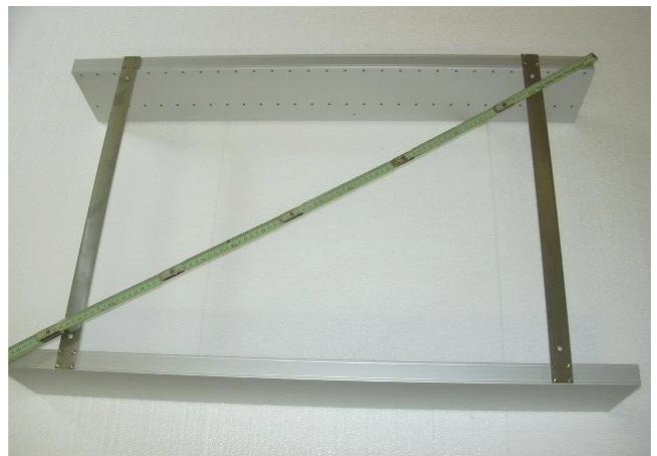
Bild B Überprüfen des rechten Winkels
