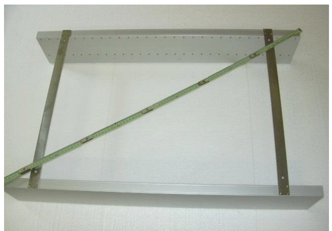
Bild B Überprüfen des rechten Winkels
